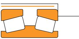
对于 TDIK、TTDK 和 TTDFLK 轴承轴向（推力）位置，轴承外径与轴承座之间需要留出更大间隙，以避免轴承承受径向负荷。因此，表中所示的配合度应当增大以达到 2 至 3 毫米 (0.080 至 0.120 英寸) 的间隙。
