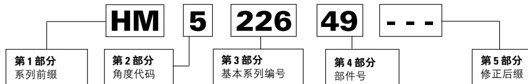
图 41. ABMA 英制部件编号系统示例。
